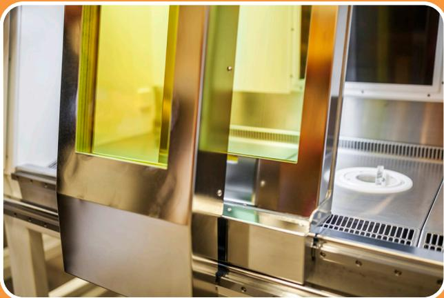
30+20-2-fach-Variante der seitlich verschiebbaren Frontabschirmung aus Bleiglas. Die beiden, voneinander unabhängigen, Frontabschirmungen können getrennt (30mm und 20mm) oder zusammen (50mm) verwendet werden.
