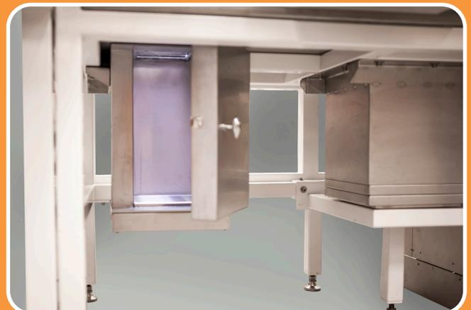
Abfallbehälter mit 50mm Bleiverkleidung und Tür zum leichten Entleeren auf der linken Seite und 50mm Bleiverkleidung für die Integration eines Aktivitätsmessgerätes auf der rechten Seite.
