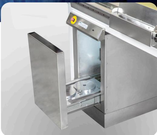
Aufbewahrungssysteme auf dem neuesten Stand der Technik ermöglichen die Unterbringung von zwei Tc-99 Generatoren oder anderer, am Markt erhältlichen, Geräte. Die Generatoren können, aufgrund des speziellen Designs, leicht ausgetauscht werden, ohne sie dabei allzu hoch heben zu müssen.
